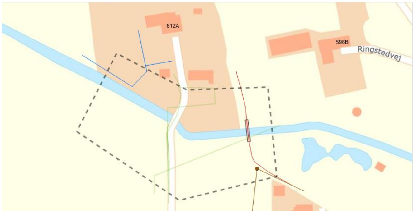
Figur 3-26: LER oplysninger fra området omkring Ringstedvej 612A, st. 7150-7350. registreret ledninger er vist med tynd streg. brønde/knudepunkter er vist med cirkler. Den stiplede linje viser afgrænsning på søgeområdet. Kilde: Ledningsejerregistret, søgt den 10 januar 2025.
